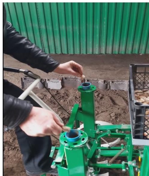
Рис. 14 - Ручная рассадопосадочная машина РРМ-2 для координатной высадки рассады, а также посадочного материала луковичных культур и зубков чеснока
