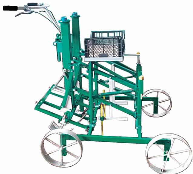
Рис. 14 - Ручная рассадопосадочная машина РРМ-2 для координатной высадки рассады, а также посадочного материала луковичных культур и зубков чеснока
